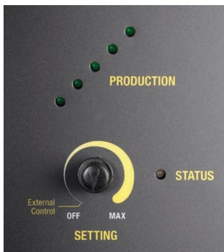
L'ingresso del controllo esterno richiede contatti privi di tensione, normalmente aperti (NO), dove contatti aperti indica che l'uscita del clorinatore è OFF e contatti chiusi indica che l'uscita del clorinatore è ON. L'uscita del controller esterno è connessa ai terminali collocati alla base del clorinatore come mostrato a pagina 30.
