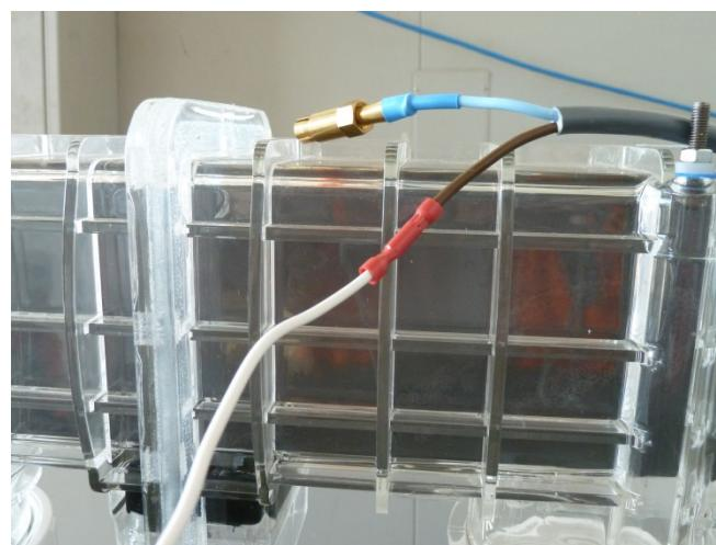
Encaixe o conector de latão no fio do interruptor de caudal no sensor de gás da célula.
