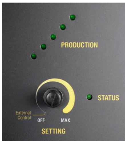
L'unità è dotata di un sistema di controllo elettronico e di allarme. Questo regola l'uscita dell'Unità fino a una valore massimo prestabilito. Il sistema di allarme consiste di un LED DI FUNZIONAMENTO che diventerà Rosso per indicare eventuali guasti dell'Unità o condizioni operative dannose.
