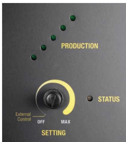
La entrada de control externo requiere contactos sin voltaje, normalmente abiertos (NA), en los que los contactos abiertos señalan que la salida del clorador está APAGADA y los contactos cerrados indican que la salida del clorador está ENCENDIDA. La salida del controlador externo está conectada a los terminales situados en la base del clorador como se muestra en la página 78.
