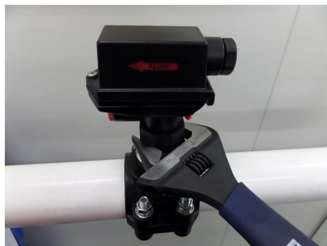
L'alignement de l'interrupteur est essentiel pour un bon fonctionnement. L'interrupteur doit être aligné avec le tuyau et la flèche d'écoulement indiquant la direction d'écoulement. Retirer le couvercle sur le boîtier électrique et insérer les fils dans l'entrée de câble. Connecter les fils aux bornes marquées « COMM » et « NO ».
