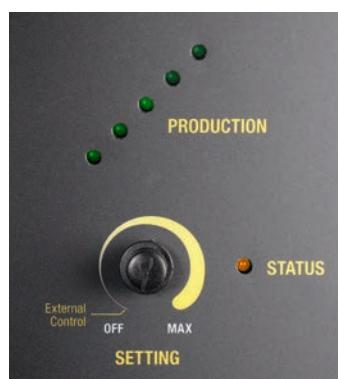
À une concentration en sel de ~ 2 500 ppm (mg/L), le dispositif EcoMatic sera éteint pour « teneur en sel faible ». À ce stade, le dispositif EcoMatic cessera de fonctionner.
