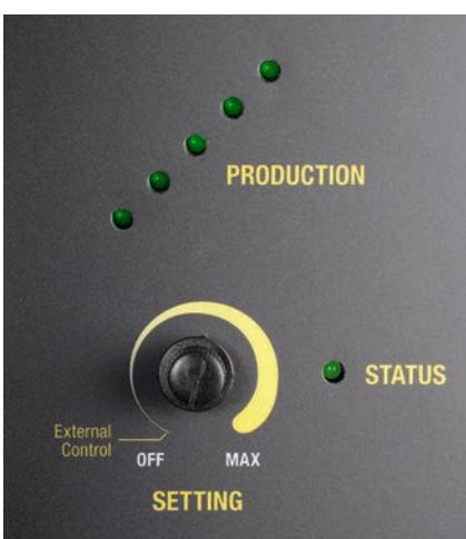
La unidad está provista de un control electrónico y un sistema de alerta. Esto regula la salida de la unidad a un máximo preestablecido. El sistema de alerta incluye un INDICADOR LED DE FUNCIONAMIENTO que emitirá una luz roja para indicar alguna anomalía en el funcionamiento de la unidad o condiciones inadecuadas.
