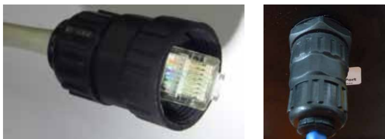
Figure 7.1: Fiche RJ45 installée dans le logement (de derrière)
