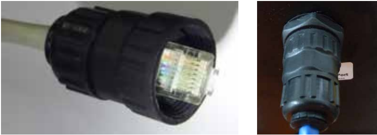
Figura 7.1 Ficha RJ45 instalada na caixa (da retaguarda)
